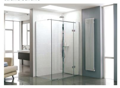
Box doccia in vetro modello AO con sistema di apertura a battente, caratterizzato dall'utilizzo di cerniere a rotazione libera e chiusura magnetica; realizzato con vetro temperato spessore 8 mm, accessori in acciaio inox e profili in alluminio.
